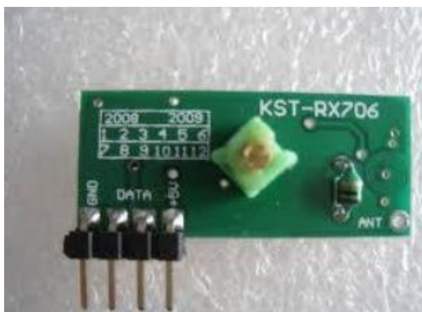
Сурет 1.8 (б) - Радиожиілікті қабылдағыш (KST-Rx 706)
